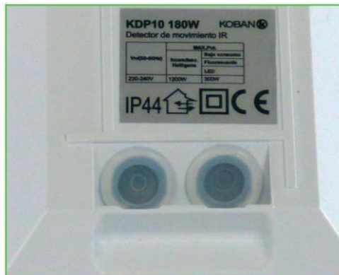
Bornas para la conexión del cableado
